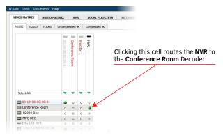
FIG. 4 ROUTING NVR TO A DECODER
