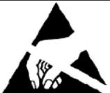
**경고:** 민감함 구성품을 ESD(정전 방전)로부터 보호하려면 내부 부품을 만지기 전에 적절한 방법으로 접지해야 합니다. 전자장치와 함께 제조된 장비를 사용하는 경우 적절한 ESD 접지 절차에 따라 사람, 제품 및 공구에 최대한 정전기가 없도록 해야 합니다. 이를 위해 특수하게 고안된 접지 스트랩, 전도성 스모크(smock) 그리고 전도성 작업 매트가 있습니다. AMX를 현장에서 정비하는 사람은 적어도 하나의 접지 코드와 정전기 분산 작업 매트를, 또다른 접지 코드와 UL이 규정한 손목 스트랩으로 구성된 적절한 ESD 현장 서비스 키트를 사용해야 합니다.
