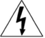
삼각형 안 화살표 기호가 있는 번개 표시는 제품 표면 내에 절연되지 않은 "위험 전압"이 존재해 감전 위험이 있음을 사용자에게 알리기 위함입니다.
