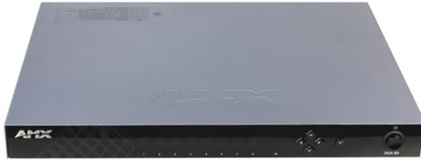
DUX-8D 8x8 HDMI矩阵（以下简称“矩阵”）提供8个信号源输入接口与8个可任意切换的输出接口，兼容HDMI 2.0与 HDCP 2.2标准，设有4路HDBT镜像输出，具有HDMI输出的模拟音频剥离能力。
